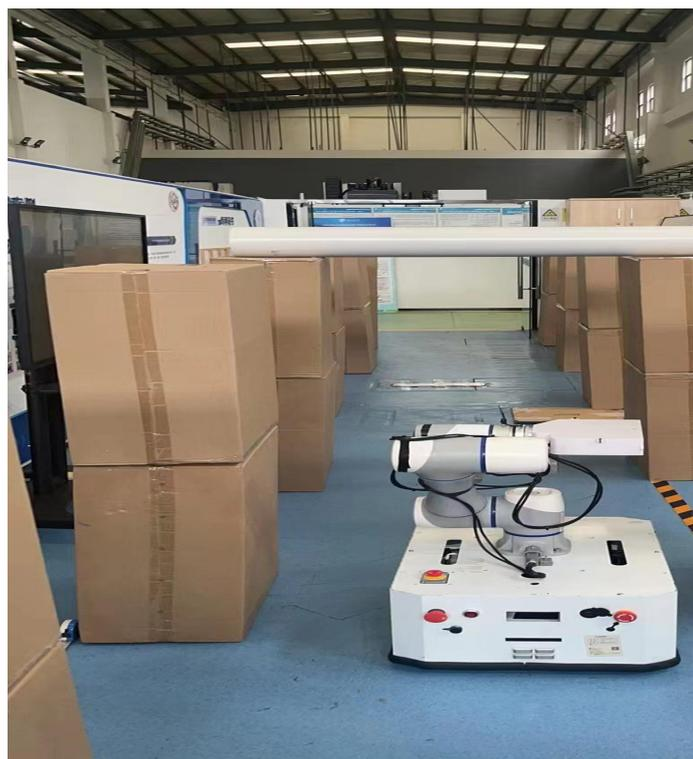
图 3 机械臂和接触网实体模型
